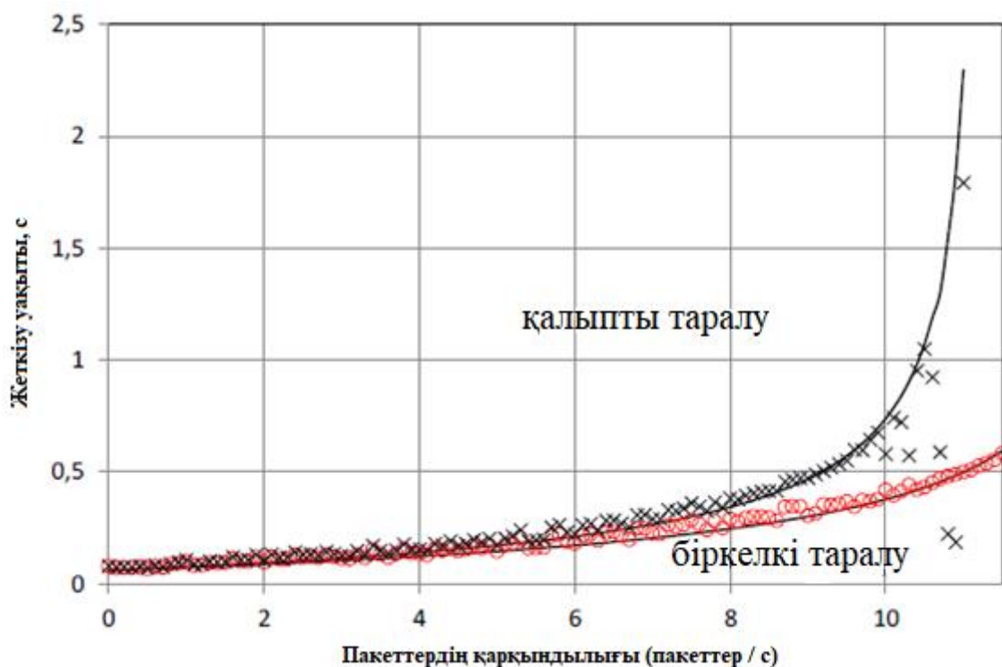
3.16-сурет – Тораптардың координаттарын біркелкі және қалыпты бөлу үшін жеткізудің кешігуінің трафик қарқындылығына тәуелділігі (орташа ұзындық – транзиттер саны 3)
